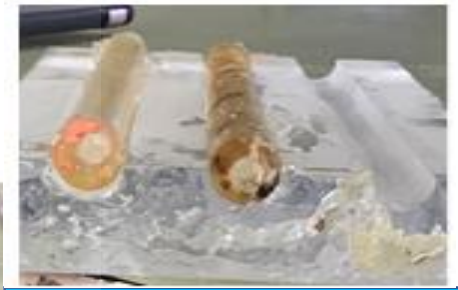
第五代模具 耐高溫、 可以重複使用、 方便脫模、拆解 不會破壞糖吸管
