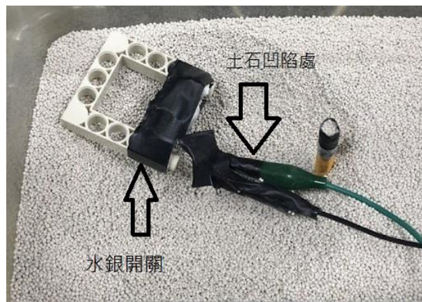
圖 6：土石滑動造成水銀開關傾斜
