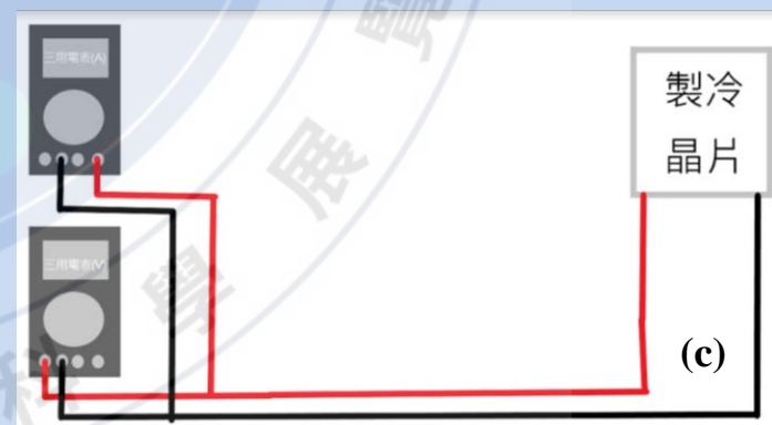
圖3-3 火鍋發電實驗裝置 (a)電晶爐、不鏽鋼鍋與製冷晶片 (b)火鍋發電實驗操作照片 (c)三用電表連接示意圖
