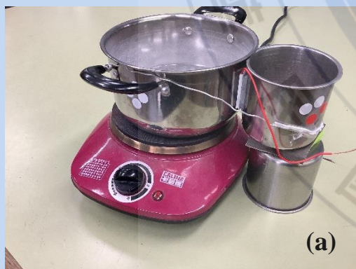
圖3-3 火鍋發電實驗裝置 (a)電晶爐、不鏽鋼鍋與製冷晶片 (b)火鍋發電實驗操作照片 (c)三用電表連接示意圖
