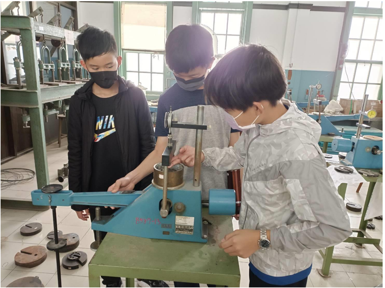
到成大土木系土力實驗室學習壓密儀的原理
