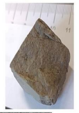
實驗前無荷重泥岩塊裂縫
