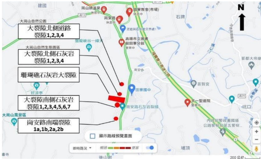
圖3-8：石灰岩裂隙測量位置平面圖
