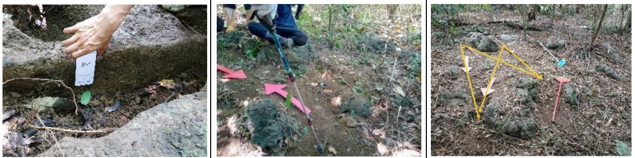
圖3-10：由垂直傾角顯示，裂隙開口稍微向上張裂，我們分別測量大裂隙南北兩側，地面斜坡上的石灰岩裂隙方位與角度。
