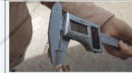
利用卡尺測量岩石厚度
