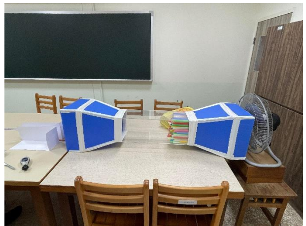
圖十四 風洞製作示意圖
