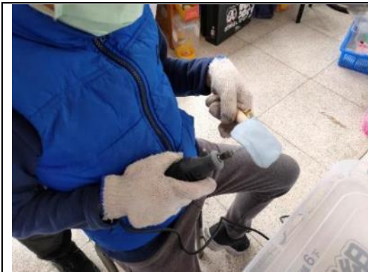
圖 39 依照大顎形狀打磨測試模型
