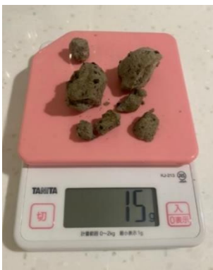
圖十七、秤取膠黏成塊狀的浮石顆粒沉積物
