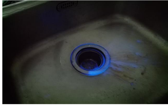
圖十五、豬肝血在魯米諾試劑下的清晰螢光，但是海藻水無法呈現這樣的顏色
