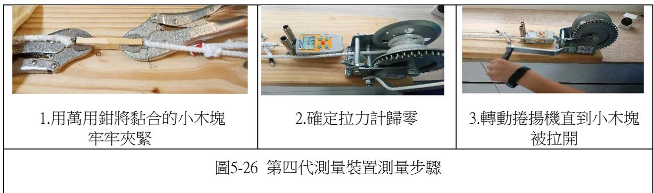
圖5-26 第四代測量裝置測量步驟
