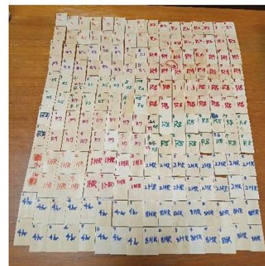
圖5-34 重複加熱實驗黏性測試的小木塊
