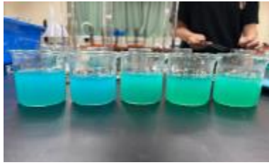
圖 5-3-8 置換一天後的硫酸銅水溶液，非常混濁
