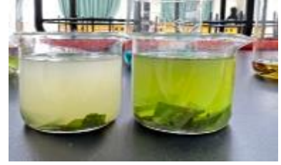
圖 5-3-13 浸泡印度榕的蒸餾水汁液依然混濁，浸泡印度榕的硫酸銅水溶液逐漸澄清
