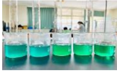
圖 5-3-9 置換四天後的硫酸銅水溶液變成澄清了
