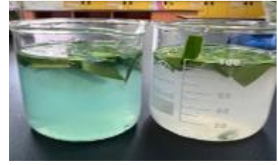
圖 5-3-10 右邊是泡在蒸餾水的印度榕葉子，混濁汁液是白色。左邊是泡在硫酸銅水溶液狀況
