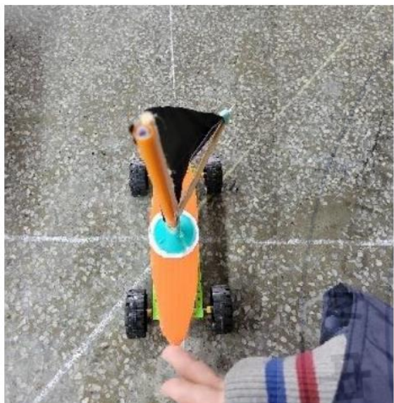
以鐵絲改變帆底部的弧形
