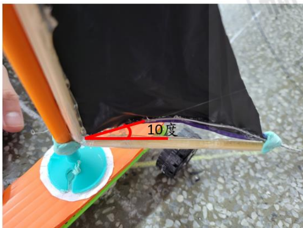
以鐵絲改變帆底部的弧形
