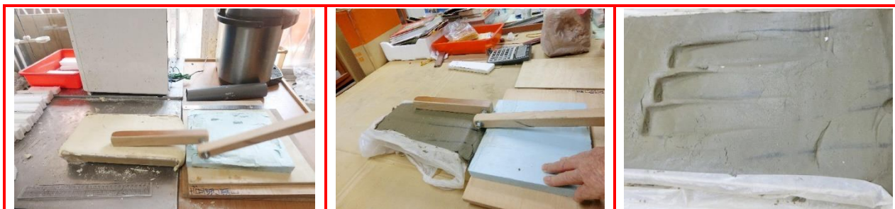
圖 39：模型連枷的敲擊板打在泥塊上，會形成凹陷的痕跡，而痕跡的模型是敲擊板前端打在泥塊上的，痕跡深表示旋轉力大。
