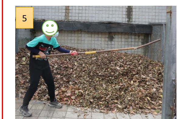
圖 16：擺動桿由最高點向下移動時，敲擊板前端也朝向地面
