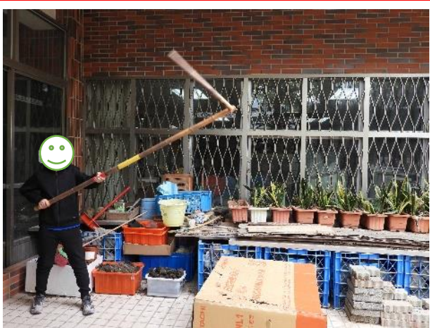
圖 8：擺動桿提高，敲擊板會以轉軸為中心向上轉動，敲擊板到達頭頂後用力向前撲下。
