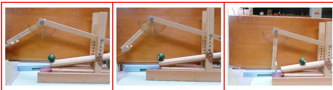
圖 31：敲擊板的旋轉角度不同撞擊力的操作
