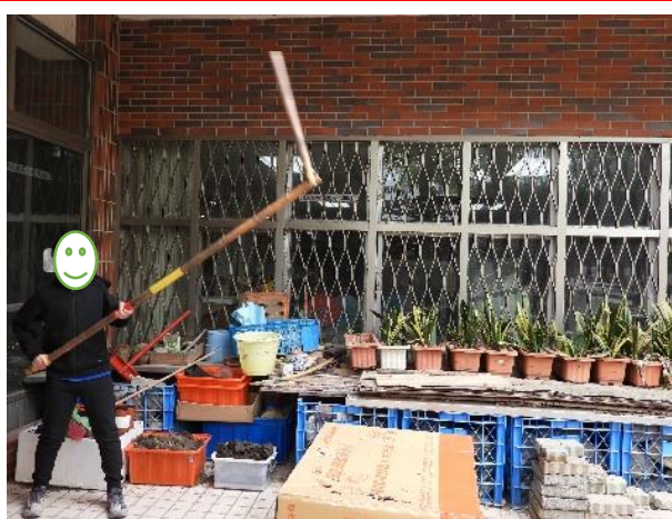
圖 8：擺動桿提高，敲擊板會以轉軸為中心向上轉動，敲擊板到達頭頂後用力向前撲下。
