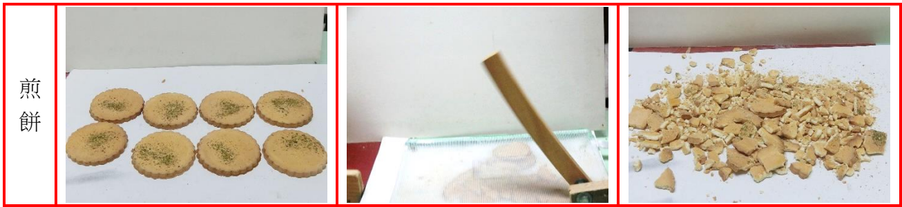
圖 47：堅硬食品用木製小型連枷模型敲擊 10 次後的成果
