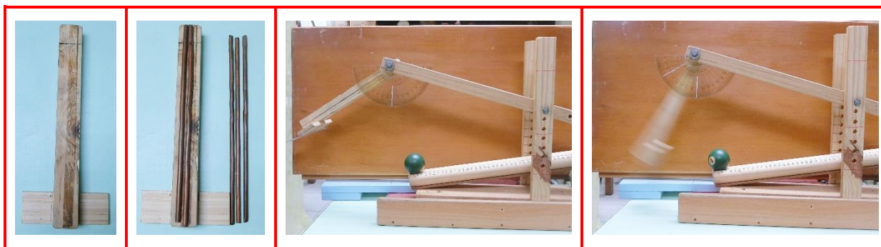
圖 33：敲擊板的重量不同，旋轉轉動的敲擊力愈大，打到塑膠球的滾動變化也不同。
