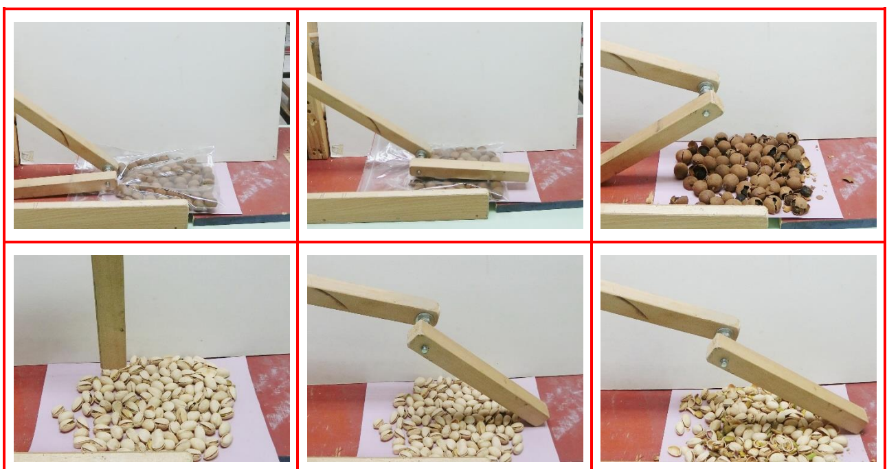
圖 44：自製的摹擬連枷敲擊豆莢果殼
