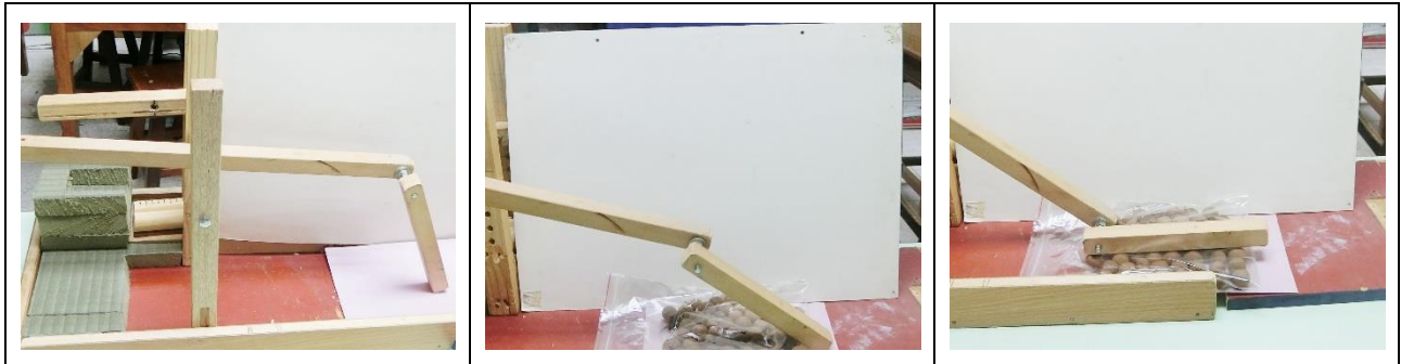
圖 43：自製的摹擬連枷敲擊過程
