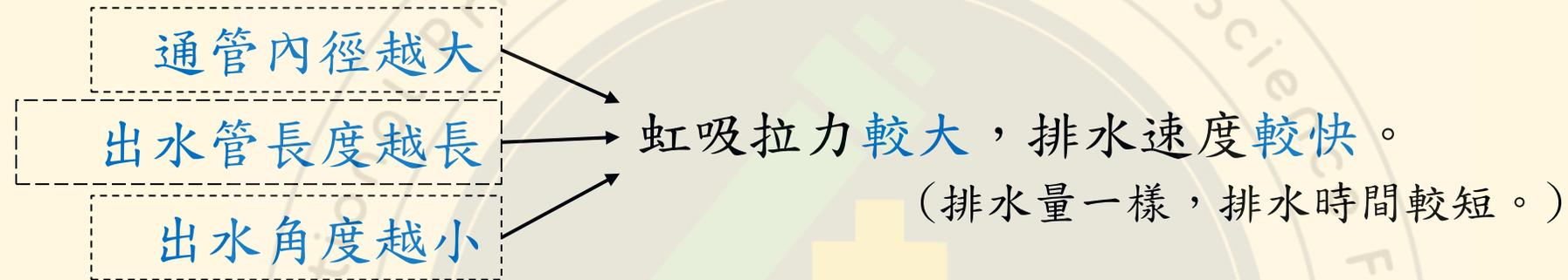
二、虹吸鐘排水速度和進水縫隙長度、罩子內徑大小和罩內通管高度無關。但在魚菜共生系統(植床部分)中有其他功能：
