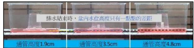
圖 49：盆內水位比較(罩內通管高度不同)
