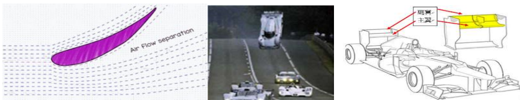
圖9. 左圖為氣流分離了翼面造成分流，下壓的力減少；中圖為車子失速現象，騰空飛起；右圖為上下兩片尾翼，前下為主翼，後上為副翼。
