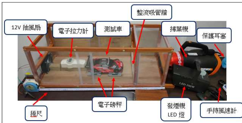
圖 19. 風洞箱內測試下壓的力及阻力變化的配置。
