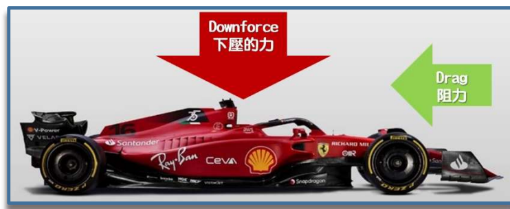
圖 4. 下壓的力 (Downforce) 及阻力 (Drag) (自繪圖)
