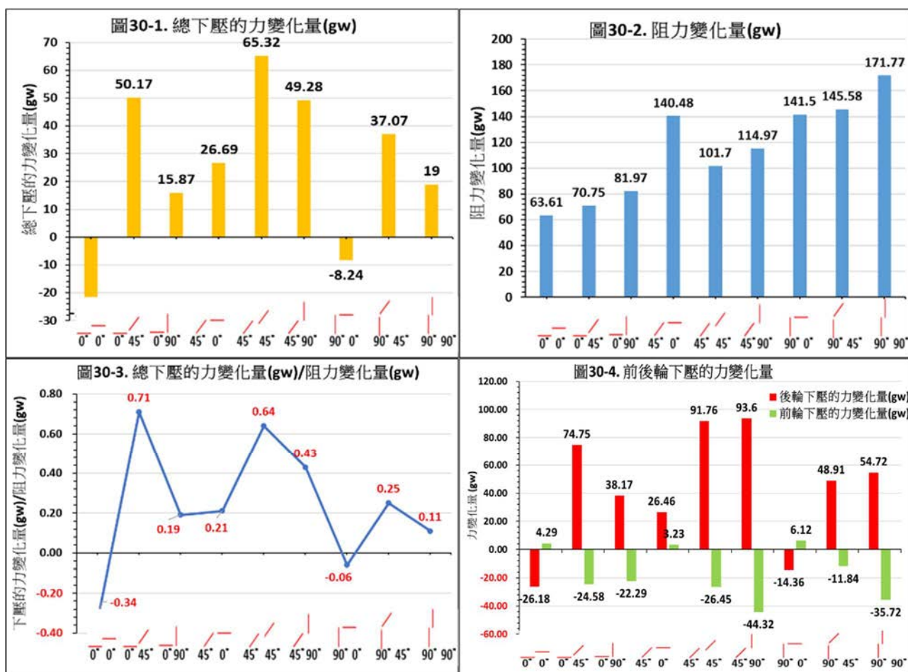
圖 30. 自製雙層尾翼的不同角度主副翼下壓的力變化量(圖 30-1)，阻力變化量(圖 30-2)，「總
