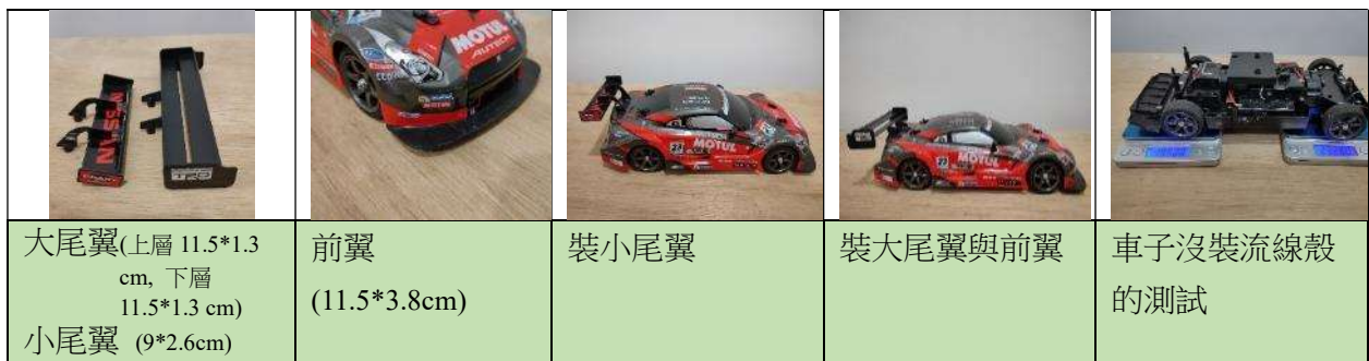
圖 20. 裝上 Nissan GTR 遙控車原有塑膠空力套件，測試下壓的力及阻力變化。
