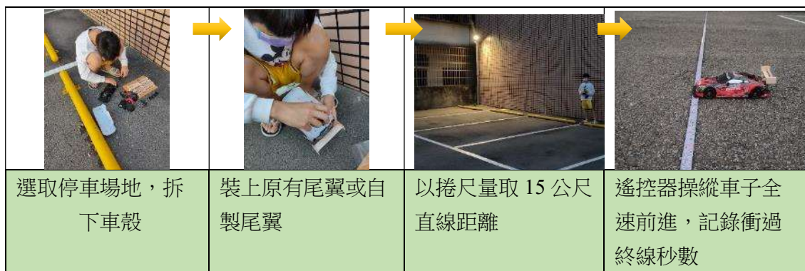
圖 23. 選取停車場地，實地測試遙控車完成 15 公尺秒數。
