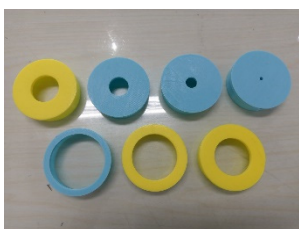
圖 17：3D 列印不同孔徑大小的瓶口蓋。 圖 18：以推膜機進行實驗，更加公平和準確。 圖 19：孔徑/管徑 = 1/3 環形氣泡效果最佳。 圖 20：孔徑/管徑 > 7/15 無法產生環形氣泡。
