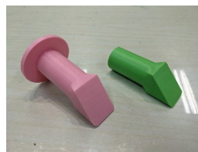
圖 30：推膜裝置推桿改變直徑，增加推力。
