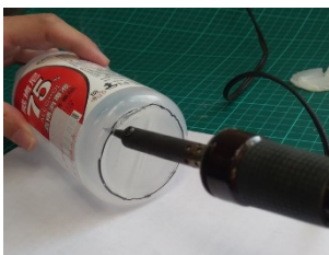
圖 5：酒精瓶瓶底太硬，老師以焊槍協助挖洞
