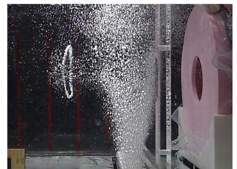
圖 45：水中懸浮的細小氣泡，可作為顯影顆粒，進行流場分析。
