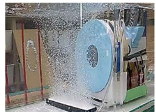
圖 32：7 吋管徑也能夠製造環形氣泡。
