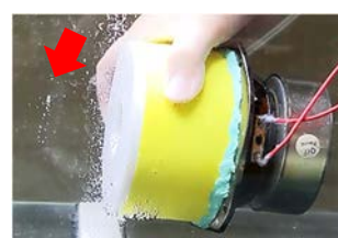
圖 51：以 4 吋喇叭製造出環形氣泡！
