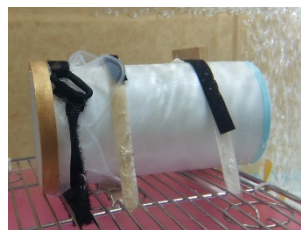
圖 11：繡框搭配 3D 列印瓶來固定彈力膜。
