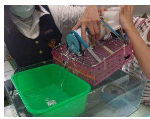
圖 41：將瓶內水倒出，測量現形水量下限。
