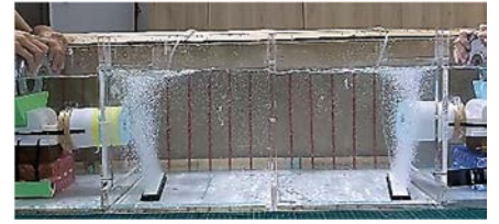
圖 44：在水缸中，兩側以推膜機製造環形氣泡對撞。
