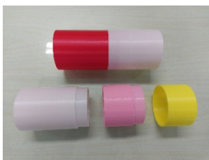
圖 21：以 5、10、15cm 圓筒，拼接各種管長。
