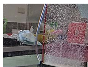
圖 55：TPU 材質方形瓶能夠產生環形氣泡。
