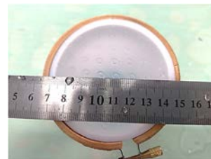
圖 15：矽膠保鮮膜方格間距 10mm，效果最好。
