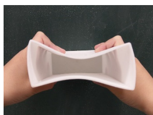
圖 54：TPU 材質印製的方瓶可以施力變形。
