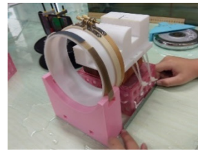
圖 27：設計支撐 5、7 吋圓筒瓶的大固定架。
