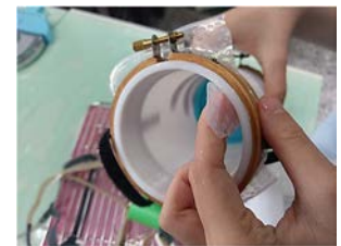
圖 16：矽膠保鮮膜拉得太緊，推膜時就破了。
