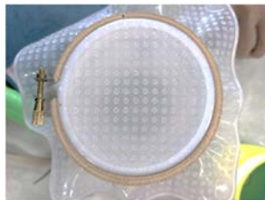
圖 14：片狀矽膠保鮮膜最適合當彈力膜。
