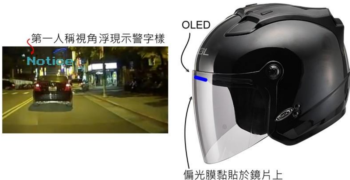
圖 25 抬頭顯示器動作原理
