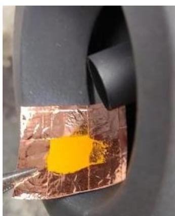
圖五十七:將鉛黃試紙放在排氣管上
