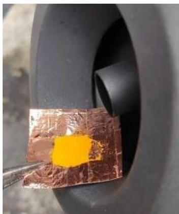
圖五十五:將鉛黃試紙放在排氣管上
