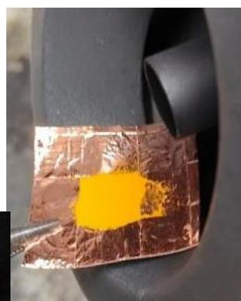
圖五十八:將鉛黃試紙放在排氣管上
