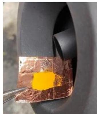
圖五十六:將鉛黃試紙放在排氣管上
