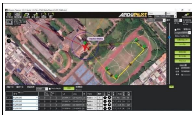
圖47、飛行航點設置示意圖
