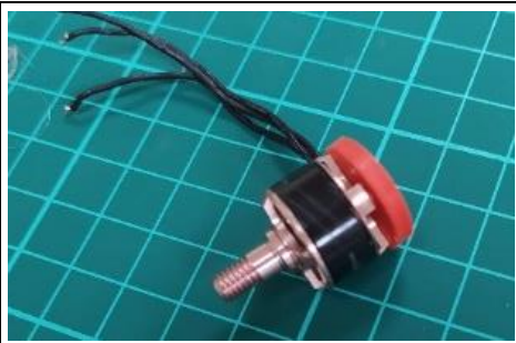
圖 28、1103 有刷馬達(58000RPM)
