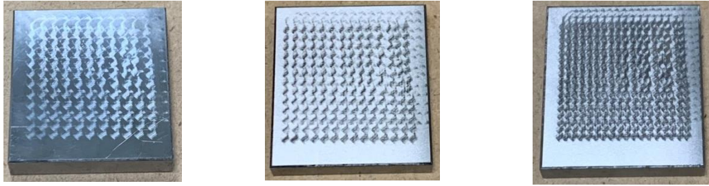
(a)一次全平面鏟花 (b)重複二次全平面鏟花 (x、y 軸偏移) (c)重複三次全平面鏟花 (x、y 軸偏移)
