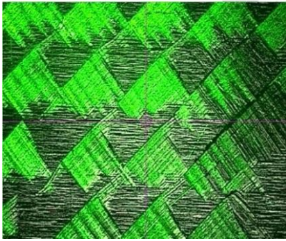
(a) 自動化鏟花承斑(綠色為顯微鏡表面光源，倍率 20X) (b) 手工鏟花鏟花承斑(參考文獻)[5]
