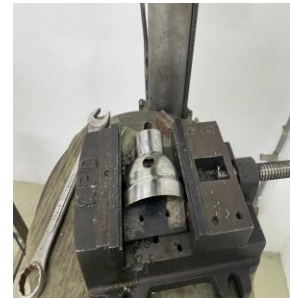
圖 48.鋼瓶洩壓孔鑽洞
