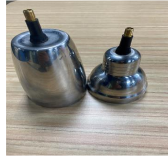
圖 42.完成氣嘴安裝
