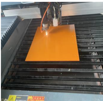
圖 37.雷射切割電木板
