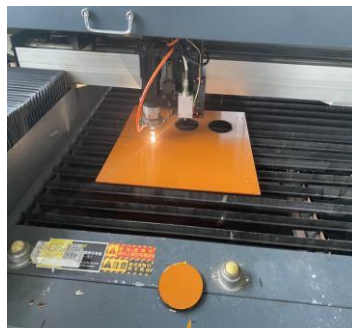
圖 38.雷射切割電木板
