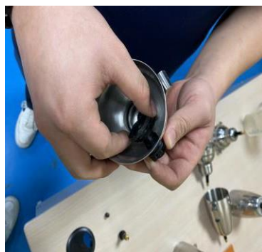
圖 52. 安裝鋼瓶密封開關
