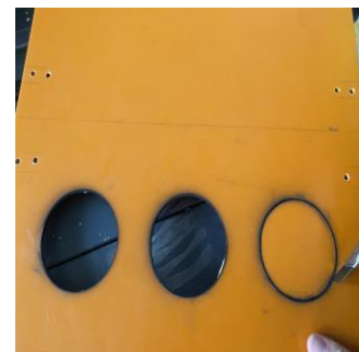
圖 39.完切割電木板
