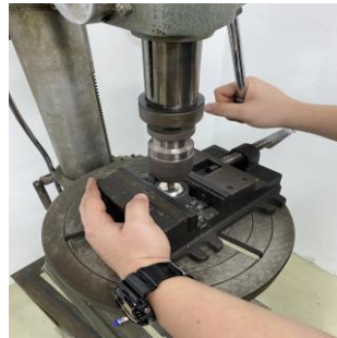
圖 47.鋼瓶洩壓孔鑽洞
