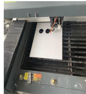
圖 36.雷射切割定位測試
