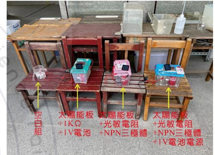
Fig24. 利用電子元件防腐蝕實驗裝置。
