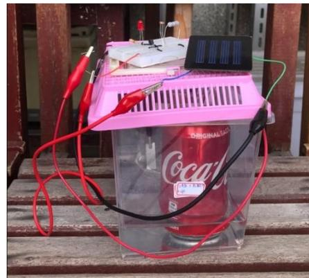
圖 12、太陽能之陰極保護及犧牲陽極法之雙重保護水面上及下受測鐵片實驗。
