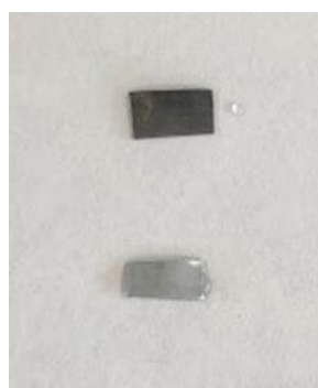
圖(十一)同樣浸泡 1M HCl 10 分鐘，有無震盪後之鋅片比較
