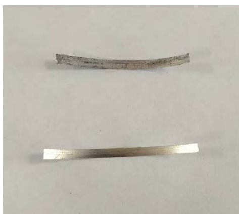
圖(九)剛拆封(上)及浸泡 1M HCl 30 秒(下)之鎂帶比較
