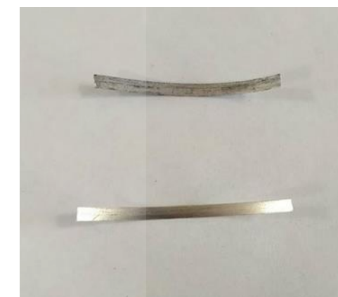
圖(二)剛拆封(上)及浸泡 1M HCl 30 秒(下)之鎂帶比較
