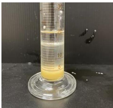
圖十二浸泡過柴油的幾丁聚醣粉末泡水後分離
