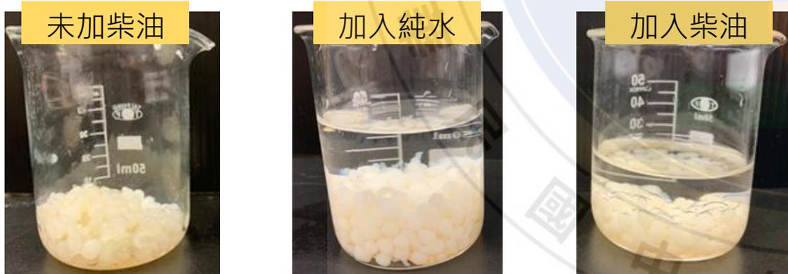
圖七、八、九 未加柴油、加入純水、加入柴油後的幾丁聚醣晶球狀態
