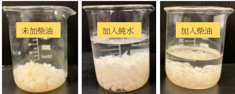
圖十三、十四、十五 未加柴油、加入純水、加入柴油後的幾丁聚醣晶球狀態
