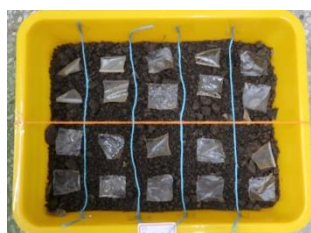
圖 7-2-a 放置生質膜於土壤上
