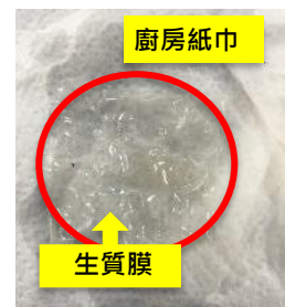
圖 5-3-a 用廚房紙巾吸收生質膜多餘水分
