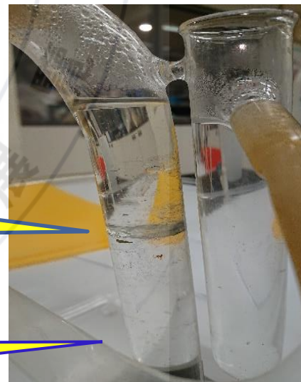
圖5. 油水分離器分離精油及純露
