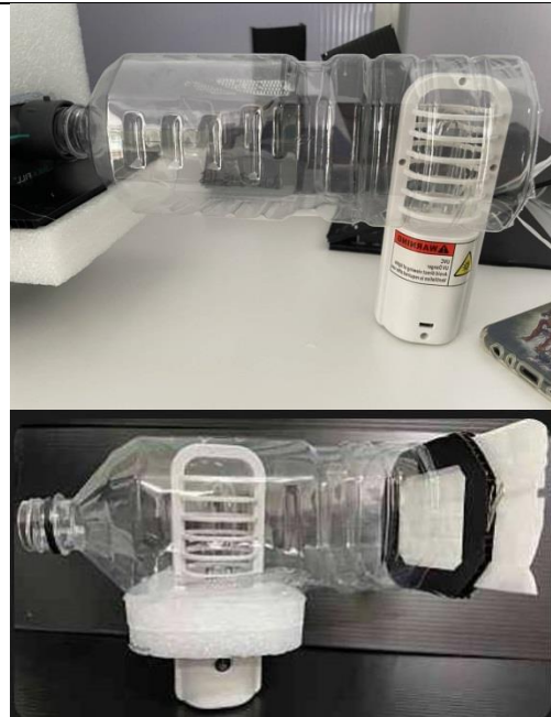
圖19 紫外燈殺菌及熔噴布過濾透明裝置
