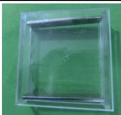
圖 5-9 將磁鐵固定在特製壓克力底部另一磁鐵自然放置
