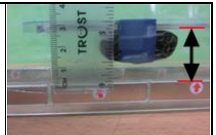
圖 5-15 磁軌在二側滑板距離約 30mm(離磁鐵邊緣距離)
