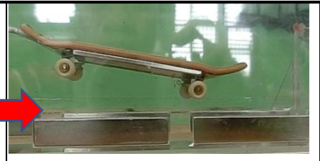
圖 5-8 滑板尾至磁鐵隙處，後方往下微的傾斜。
