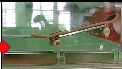
圖 5-7 磁鐵在軌道兩側時，在滑板空隙處依然會傾倒，只是傾斜幅度比磁鐵在下方小很多
