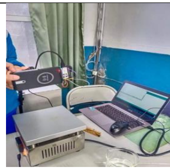
圖 2-13 將感測器用懶人支架固定於加熱板上方
