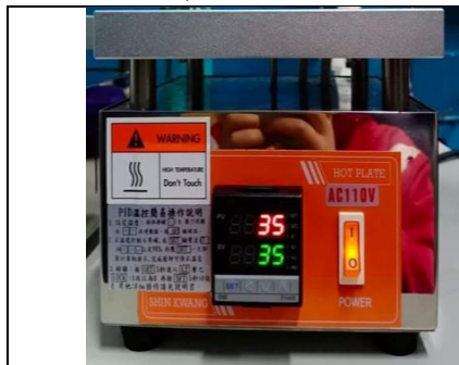
圖 2-11 將加熱板設定加溫到 35 度
