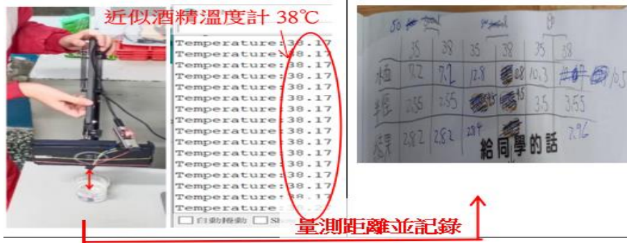
圖 3-13 調整 MAX90614 距離水面的高度，直到量出接近實際水溫的溫度
