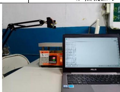
圖 2-13 將感測器用懶人支架固定於加熱板上方
