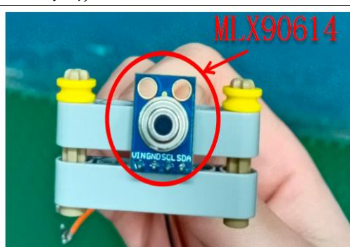
圖 3-10 用樂高零件組裝架設非接觸類型感測器(MLX90614)
