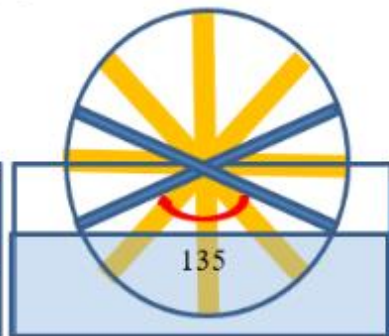
高水位能入水達 135°，六漿葉可入 3 漿、三~五漿可入 2 漿、二漿入 1 漿
