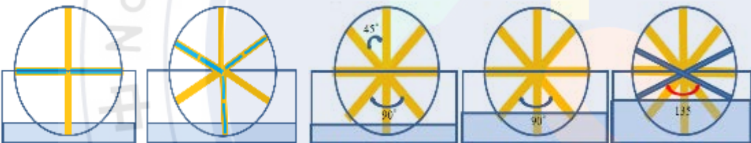
一槳轉動90°浸入水區域的顯示 三槳為60°浸入水區域的顯示 低水位顯示每次只能入水一槳葉 中水位能入水二槳90°，即六槳均可同時入二槳葉 高水位能入水三槳135°，六槳即可入三槳、五槳可入三槳、二槳入一槳
