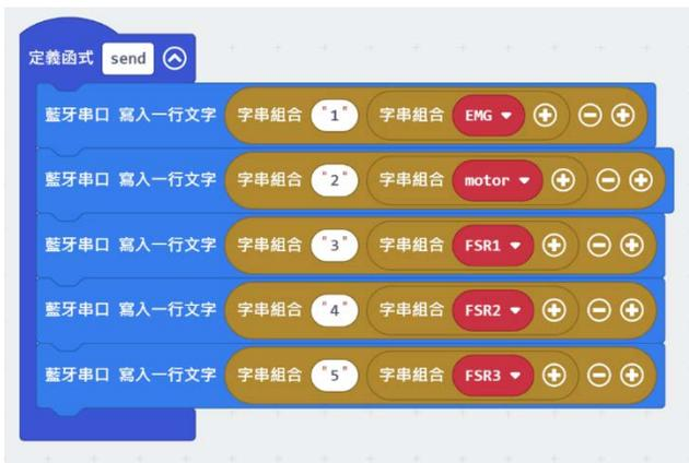
圖 416、定義 Micro:bit 藍牙寫入之函式畫面
