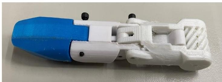
圖 4.6(左)、義肢手掌下部與替換指骨印製完成實體圖。圖 4.7(右)、多色彩手指實際安裝圖。
