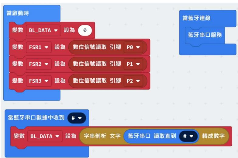
圖 4.13、Micro:bit 啟動時與藍牙功能程式畫面
