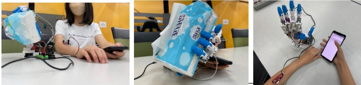
圖 5.5、實際使用智慧型手機操作智慧義肢抓取物品。
