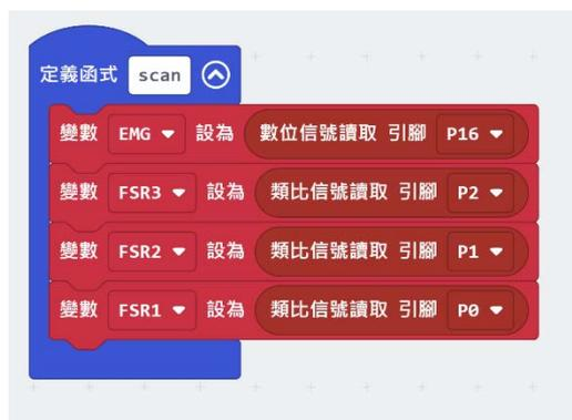
圖 4.14、定義 Micro:bit 讀取各腳位之 scan 函式畫面
