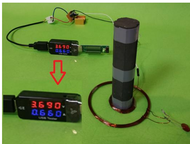
圖 5-15、本組所設計的電路，兩線圈距離 3 公分所感應的電壓及電流
