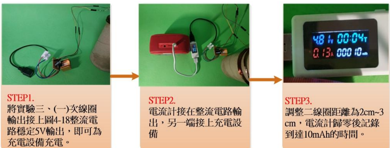
圖4-19 主線圈加入軟鐵對充電時間之影響實驗步驟
