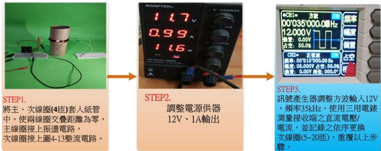
圖 4-14 次線圈匝數對輸出電壓及電流之影響實驗流程圖
