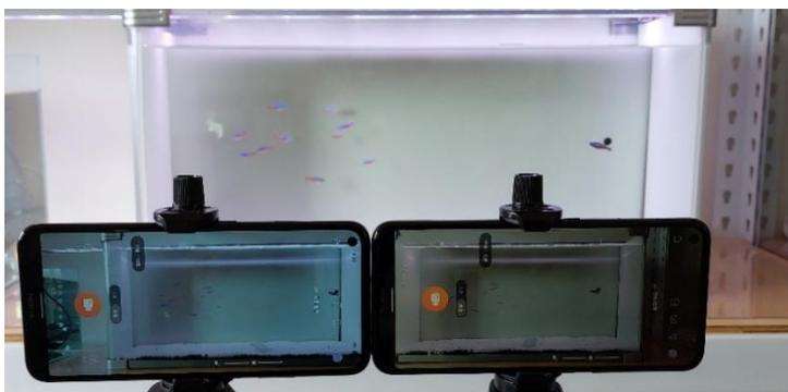
圖 4-4-6：以兩支鏡頭同時進行拍攝以計算深度
