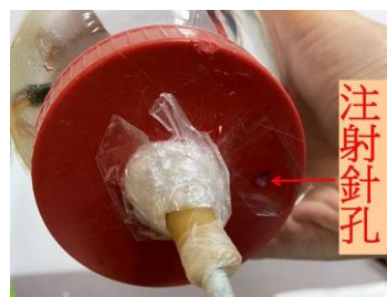
圖 6：填補橡皮管和線材周圍的縫隙
