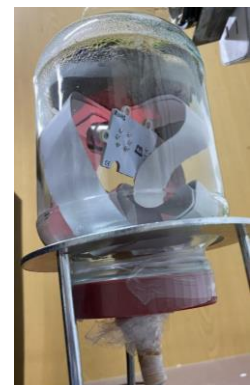
圖 31：模型內的感測器與瓶口密封
