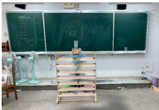
圖 1. 間隔 15 公分的擾流板裝置
