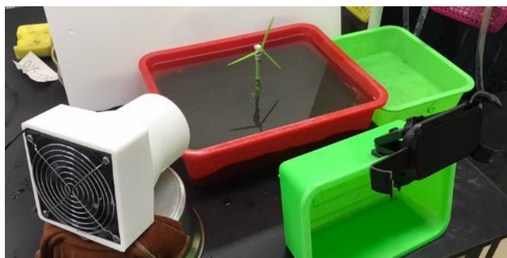
圖 27.測風力大小對風機穩固度影響的實驗架構圖
