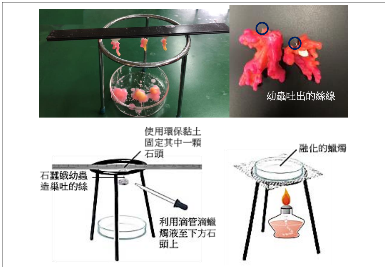
圖八：幼蟲絲線黏性測試裝置
