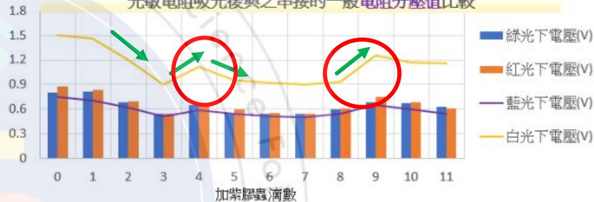
圖18、0.1M AgNO 3 +2滴紫膠蟲加不同滴數0.1M CuCl 2 溶液在不同色光光罩下，偵測光敏電阻吸光後與之串接的一般電阻分壓值比較
