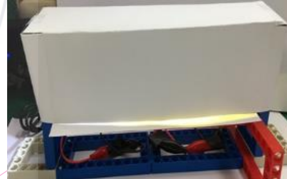
取代日光、不怕陰雨及光源強度不一且配合自製變色膜四個十字圓投影片位置的白光光照裝置 (光源強度成控制變因)
