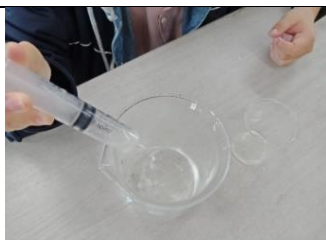
圖60 蛋殼粉海藻酸鈉溶液滴入氯化鈣溶液
