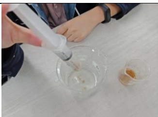
圖63 將花生殼粉海藻酸鈉溶液滴入氯化鈣溶液中
