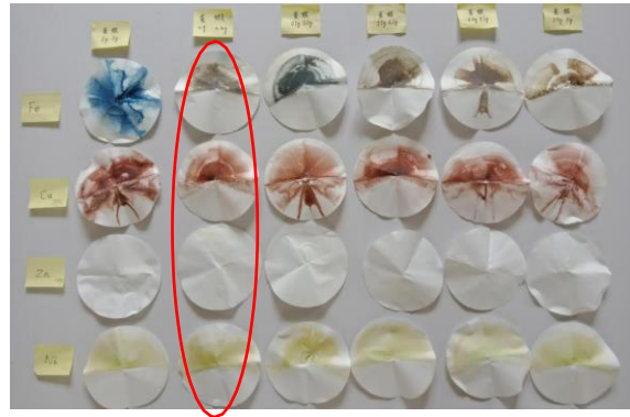
圖97不同混合比例小晶球吸附一周後 圖98黃血鹽滴定不同混合比例小晶球吸附重金屬離子
