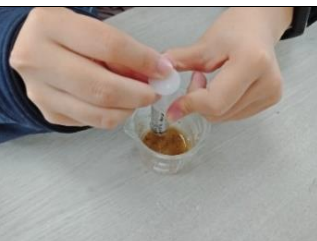
圖62 針筒吸取花生殼粉海藻酸鈉溶液
