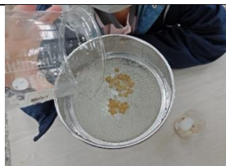
圖64 篩網過濾包覆花生殼粉海藻酸鈉晶球
