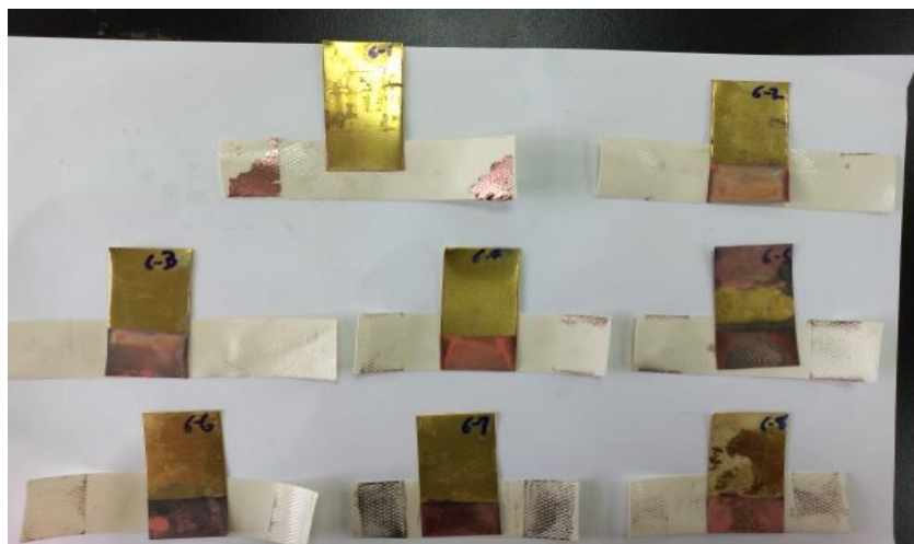
圖 27、加了氯化鈉的電鍍銅溶液幾乎不剝落
