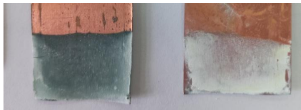
圖 24、添加氯化鈉溶液後電鍍後的正極銅片
