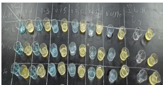
2. 將 10ml 的硫酸銅溶液加入 40ml 蛋白液中，並順時針攪拌一分鐘
