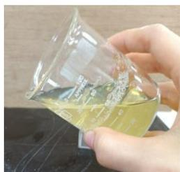
▲ 圖 4  $[\text{NaOH}] = 0.01\text{M}$  的蛋白液
