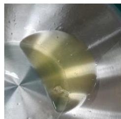
▲ 圖 5  $[\text{NaOH}] = 0.1\text{M}$  的蛋白液
