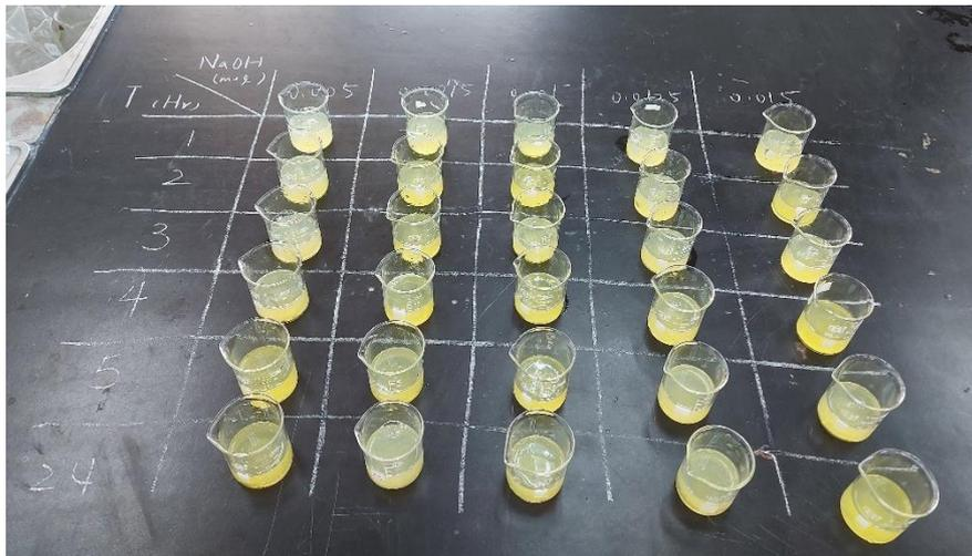
5.觀察與記錄各組在不同時間點的凝結狀況，並利用凝膠強度觀測儀分別測定各組蛋白凝膠之凝膠強度及記錄數據。
