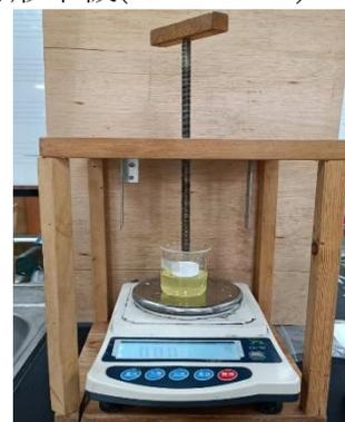
▲圖 6 凝膠強度觀測儀
