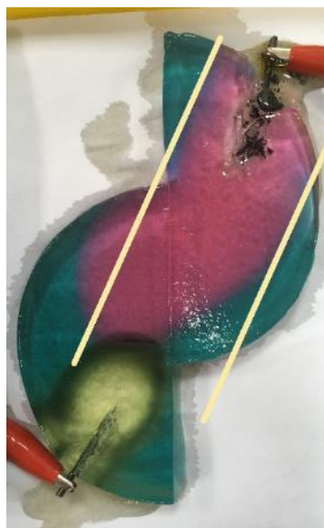
圖 22 路徑重組對離子流動情形的影響實驗結果俯視圖
