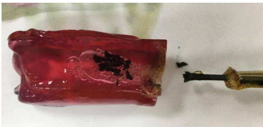
圖 12 正電極碎裂圖
