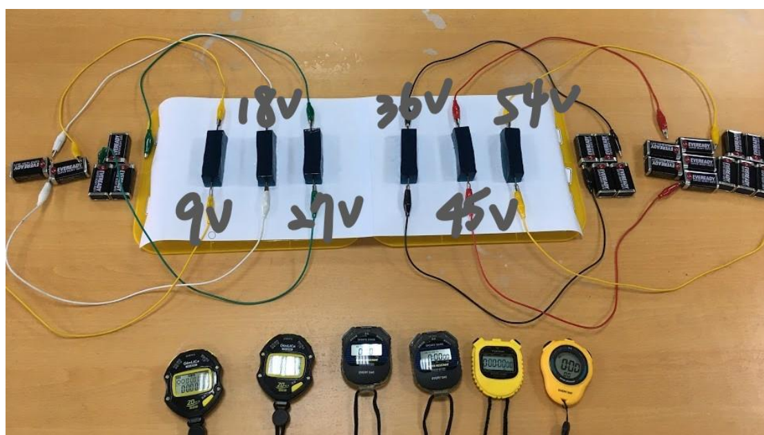
圖 7 電壓大小與電解速率的關係實驗裝置圖
