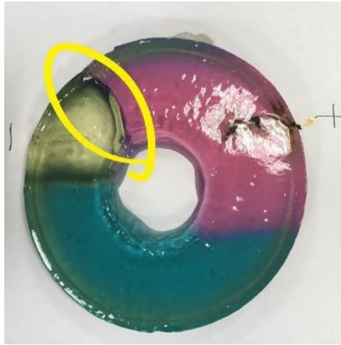
圖 21 路徑距離不同對離子流動情形的影響實驗結果俯視圖 (兩色交界處斷裂)
