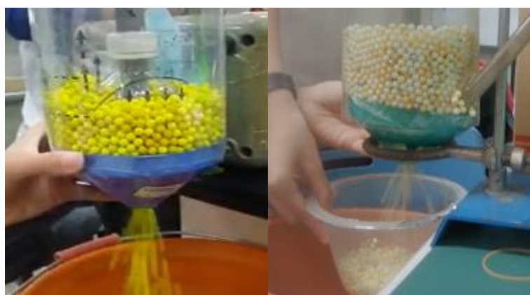
圖 6-10-2 飼料堆積高度對出料量的影響實驗
