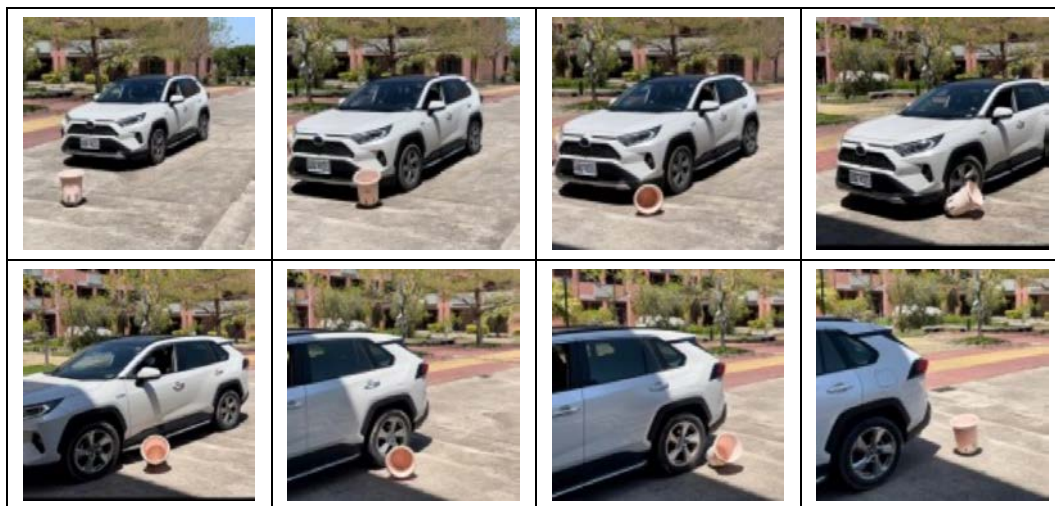
圖卅二：以垃圾桶改裝之不倒翁分隔桿
