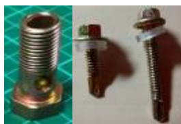
圖2-9左至右，為有孔柴油螺絲、8分、寸2自攻螺絲
