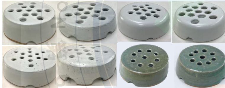
自行設計不同構造條件的防溢器
