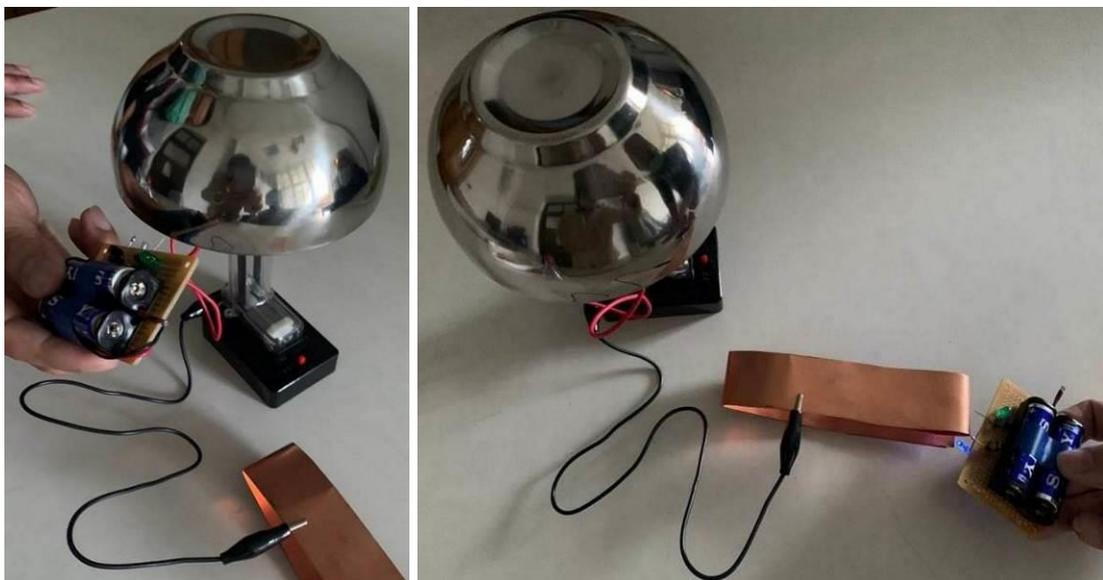
圖十三：正負電荷檢測器測試效果
