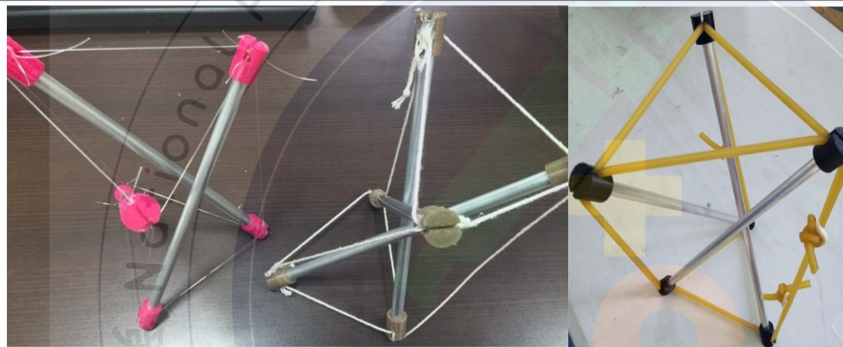
上方左圖，弦的材質為釣魚線的型二拉張結構；中間圖片：弦的材質為棉線的型二拉張結構，右方圖片：弦的材質為橡皮的型二拉張結構
