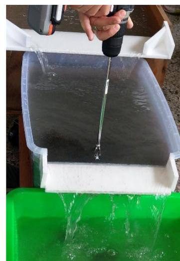
利用攪動機在固定位置攪動泥沙
