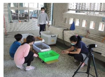
七、研究三探討水庫壩體底孔位置實驗中，發現以底孔位置 4cm 高所流出的泥沙量最多，討論認為這個位置的孔洞剛好位於鋪沙 6cm 高度之下方，接近與水的交界面(如下圖)，因此，當擋水片打開時，水流就會很快的帶走泥沙，而且持續一小段時間，直到底孔周邊的泥沙都流掉了；而底孔位置 8cm 的組別因為底孔沒有接觸到泥沙，因此只有少量泥沙隨著水流流出，大部分都是清水。另外發現各組別操作時打開擋水片的瞬間，流出的泥沙量最多，隨著水量慢慢減少，流出的泥沙量就變少了。
