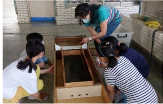
(2)待水槽內的水靜止後，啟動抽水馬達以出水孔徑 3mm 水流量抽水，使水從上給水槽漫流進入主水槽後，同時抽掉擋水片，這時水流動挾帶泥沙從水閘門孔洞流出，再流至下集水槽中，1 分鐘後關閉水流。
