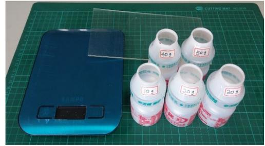
(2)在管內倒滿水，待水靜止後，由圓管上方固定位置倒入 10 克重 0.42-1mm 顆粒大小的泥沙，並開始計時。
