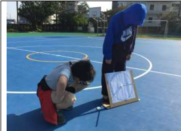
圖三十三 安置赤道式日晷進行觀察，日晷的晷針必須指向正北方
