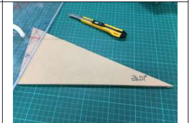
圖三十 製作地平式日晷的晷針
