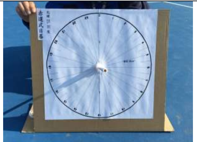
圖三十四 安置赤道式日晷進行觀察，日晷的晷針必須指向正北方
