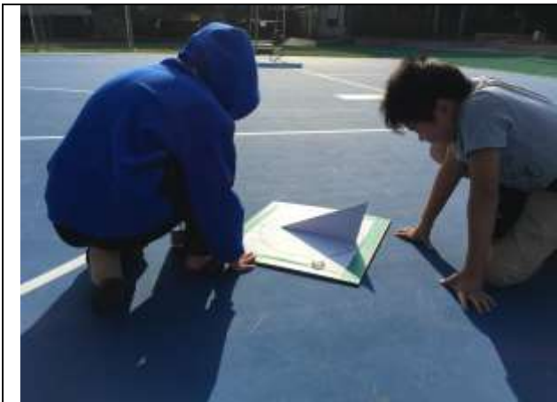
圖三十五 安置平面式日晷進行觀察，日晷的晷針必須指向正北方
