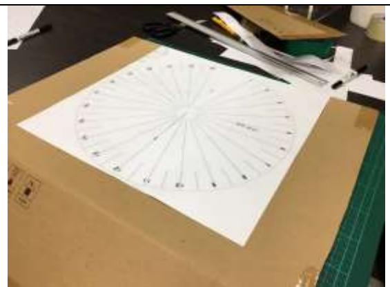
圖二十二 製作赤道式日晷的晷面與基座
