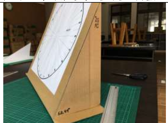
圖二十四 固定赤道式日晷的晷面與基座
