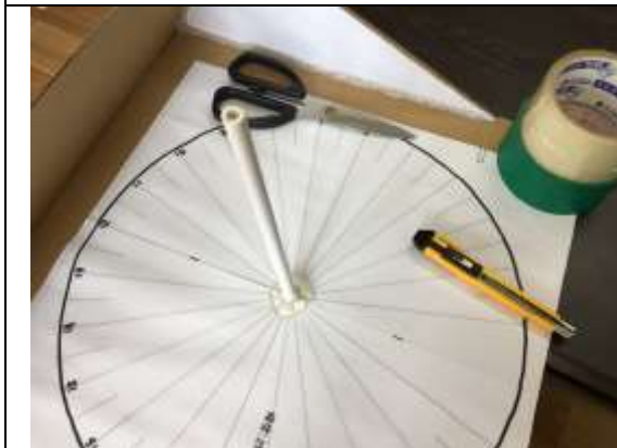
圖二十五 固定赤道式日晷的晷針
