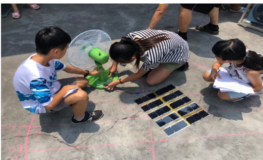
圖 51.直接使用驅動 DC12V 風扇
