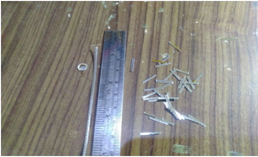
圖 41.將焊帶裁切成 1cm 長度
