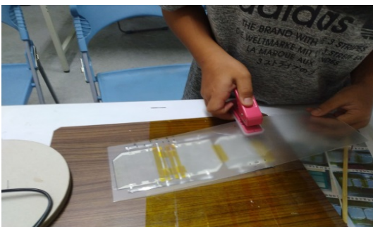
圖 45.標註正負極處進行打洞
