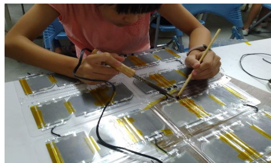
圖 48.打洞處進行串接與二極體焊接
